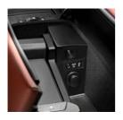
Zur Nutzung der Audioplayerfunktionalität eines Handys im Fahrzeug über die USB-Schnittstelle bietet die BMW Group für aktuelle BMW Neufahrzeuge (ausgenommen X3) die USB-Audio-Schnittstelle (SA 6FL) an. Detailinformatio-
